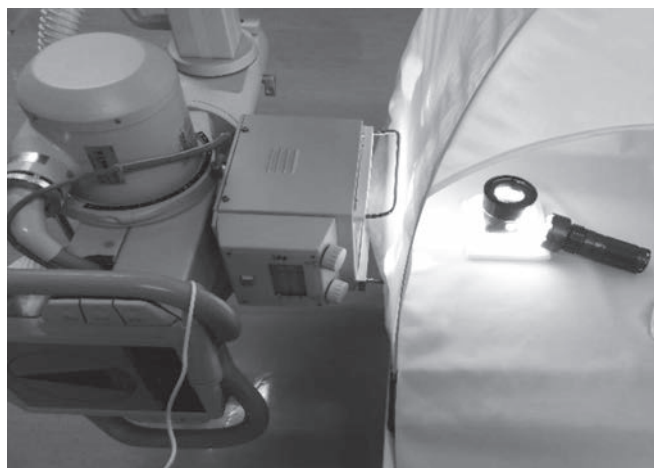
画像 10: ウィルソンが「雲生成にはイオンが必要」と証明した手順の再現を行った。X線による霧の発生を観察するために、霧箱の外からX線（過飽和気体の部分で 200mGy/s）を 0.5 秒間照射した。肉眼でわずかに薄く底面に霧が発生するのが確認できたが、残念ながら撮影できる程度の霧を発生させることはできなかった。X線の場合は \alpha 線や \beta 線と異なり一様に霧が発生する事と、過飽和気体は「図 1」のように底面に薄くしか生成されていない事が分かった。
