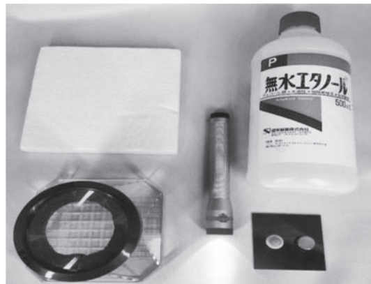
画像 4: 拡散式霧箱の材料 右下から線源、磁石、光源、容器、断熱材、無水エタノール★セットに入っていない物も含まれています
