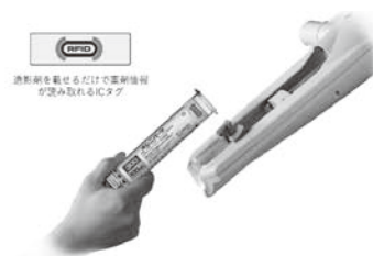
Fig3, ICタグ情報を読み取り可能な注入器
