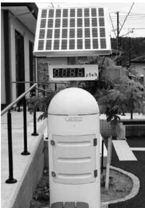
左の写真はモニタリングポストです。モニタリングポストとは、空間線量率を継続的に測定する装置です。原子力災害・事故などが起きた際には、この測定データは住民避難などの対策に活用されます。
