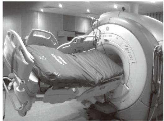
図 2 MRI 装置に吸着したベッド
