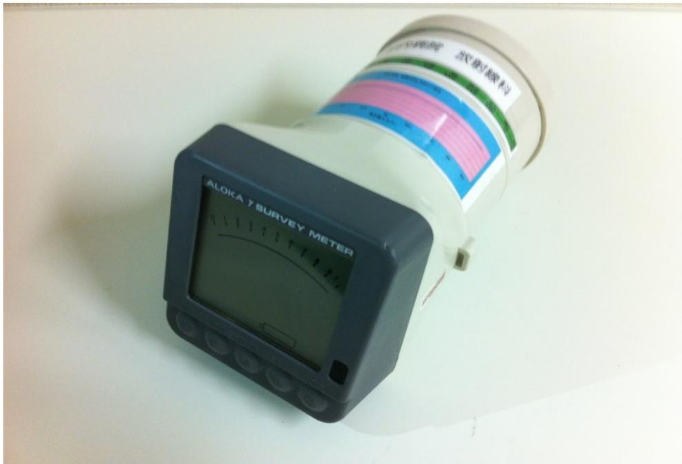
最も原理に忠実な線量計。放射線のエネルギーに左右されず正しい線量を得ることが可能。
