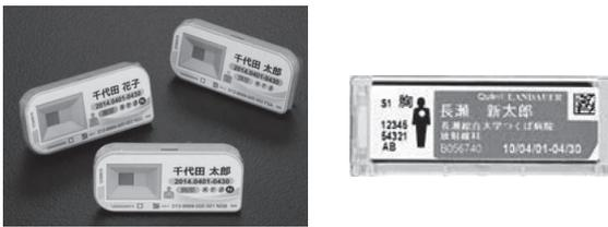
a) 蛍光ガラスバッチ線量計 b) 光刺激ルミネセンス線量計
