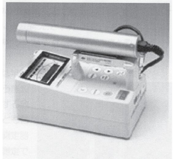
図1 シンチレーション式サーベイメータ
