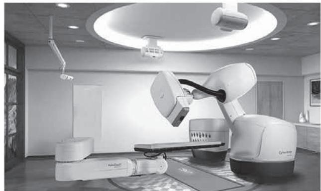
ロボットアームによる追尾照射装置
