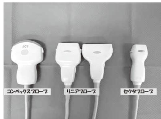
図 2. プローブ（探触子）
