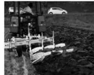
プラウ(耕起作業機)による反転耕(30cm) 出典:農林水産省
