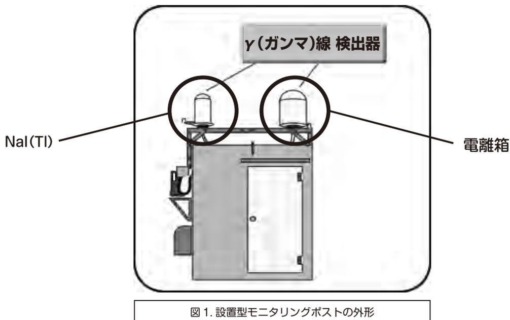
図 1. 設置型モニタリングポストの外形
